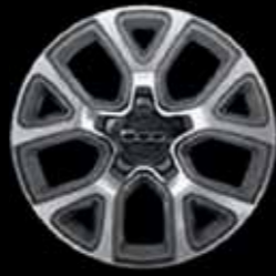
433 - mat siva aluminijumska felna od 17 inča u dve nijanse sa dijamantskom završnom obradom (standardna na modelu Cross, opciona na modelu Cross Plus)
